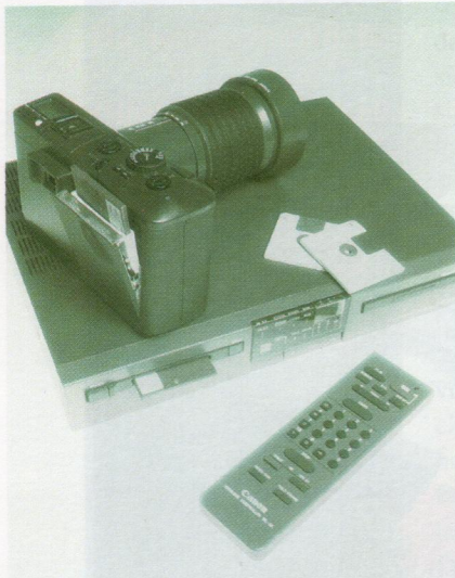
„Canon Still Video Camera RC 760“: Die Zwei-Zoll-Diskette faßt bis zu 25 Voll- oder 50 Halbbilder
