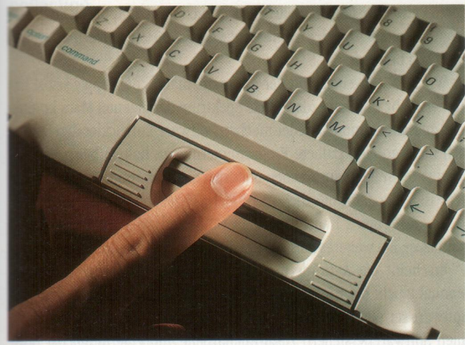
Abbildung 2: An der Unterkante der Tastatur liegender Isopoint. Für eine vertikale Cursor-Bewegung dreht der Anwender die dunkelblaue Stange, für eine horizontale verschiebt er sie nach links und rechts – die sichere Bedienung erfordert einige Übung.
