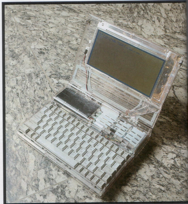
Vollendung des PC-Konzepts: Compaq LTE mit durchsichtigem Gehäuse. Gut zu erkennen ist die gedrängte Bauweise; links unter dem kupferfarbenen Kabel befindet sich die Festplatte, rechts das Diskettenlaufwerk. Der Akku (schwarz) ist austauschbar, allerdings bleiben die Daten nicht wie beim Macintosh Portable erhalten.
