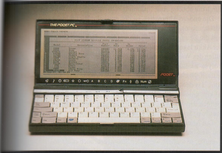
Auf neuen Wegen: IBM-kompatibler Laptop von Poquet – leichter als 500 Gramm, kleiner als eine DIN-A5-Seite und 100 Stunden Laufzeit mit zwei Mignonzellen.
